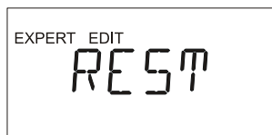
Fig. 57. Affichage visualisé affiché après avoir tourné le BPR sur «REST»
