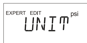
Fig. 54. Affichage visualisé après la sélection d'une autre unité
