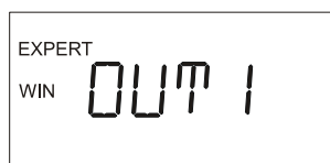
Fig. 63. Configuration de la sortie 1 comme fenêtre de contrôle de pression «WIN»
