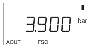
Fig. 30. Affichage visualisé après avoir tourné le BPR
