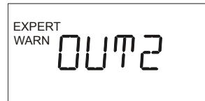
Abb. 64. OUT2 als WARN-Ausgang konfiguriert
