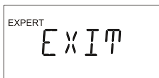
Fig. 56. Schermo del display dopo la rotazione del PPR fino alla fine della sequenza del display
