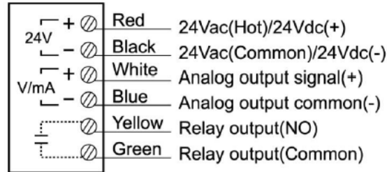
Fig. 4 wiring diagram
